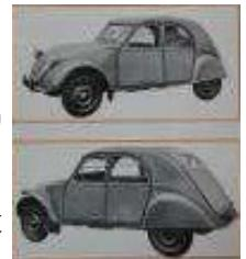
Elle doit pouvoir transporter 4 personnes et 50 Kg de bagage à 60-65 Km/h en ligne droite sur route plate. Elle doit durer 50 000 Km sans que l'on ait à remplacer aucune pièces. Une voiture susceptible d'être réparée et réglée par le client le plus ignorant, des éléments faciles à démonter ou très accessibles afin de réduire les durées d'immobilisation.
