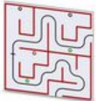
Le support de l'épreuve est une plaque de bois de dimension 2 \* 1 mètre. Il est délimité par une bordure fixe de 60 mm de hauteur percée d'une ouverture de 400 mm de large sur un coté.
